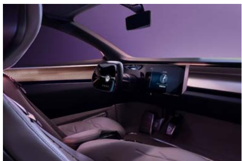
Digitales, glasüberbautes Panel mit Cockpit und Lenkrad schwebt optisch im Raum vor dem Fahrer.
